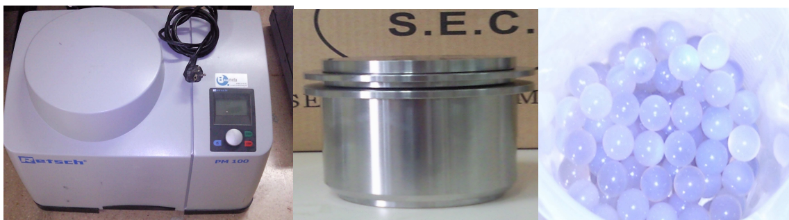
Fig 13. Molino planetario, crisol y bolas de Ágata
