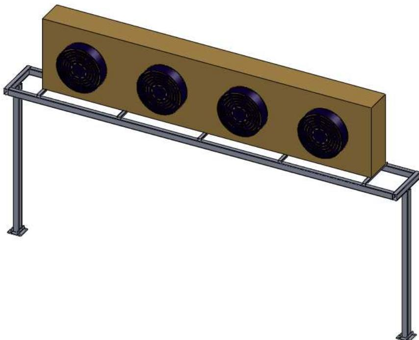
La estructura está formada por dos travesaños de sección rectangular de 70x50x4mm con una longitud de 4,3 metros. Las vigas, de la misma sección tienen una longitud de 0,5 metros. Los dos pilares son de sección cuadrada 70x70x6mm con 1,7 metros de altura. La distancia entre pilares es suficiente para albergar el segundo de los aerogeneradores que irá colocado entre ellos.
