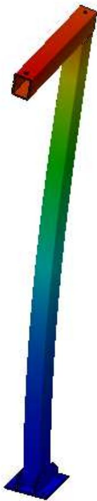
Se muestra la deformada de la estructura en caso de alcanzarse una carga a compresión 85 veces mayor de la actual, es decir 99.450 N.
