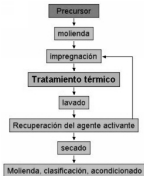
Figura A3.7. Diagrama de la activación química.
