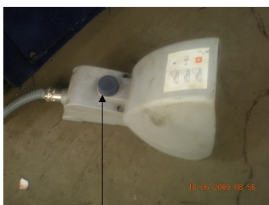
PEDAL DE MARCHA CON DISPOSITIVO DE HOMBRE MUERTO
