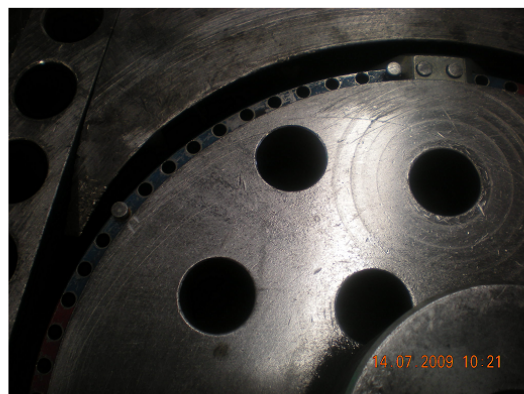
TORNILLOS DE GIRO Y FINAL DE CARRERA
