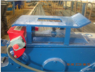
SETA DE EMERGENCIA (SOLO PARA PARADAS DE EMERGENCIA)
