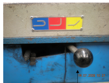
PALANCA DE SELECCIÓN DE ANGULO DE DOBLADO
