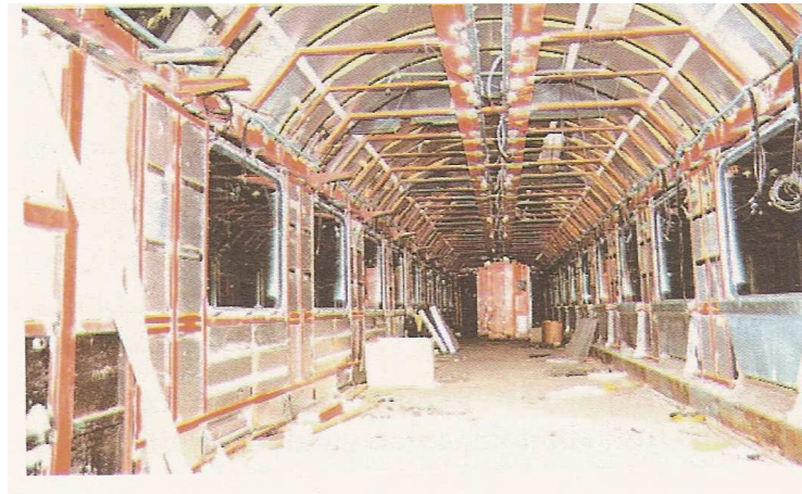
FIGURA I.XII Estructura de un coche en construcción.
