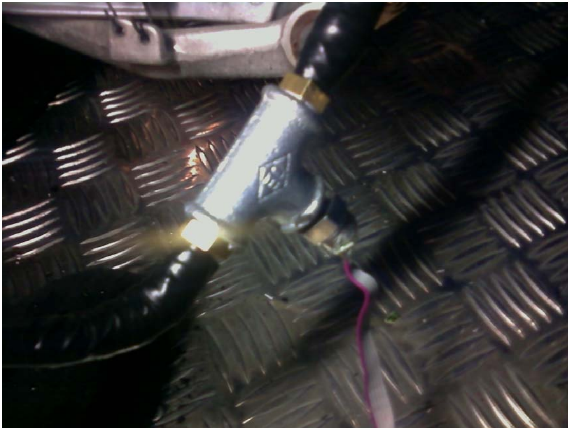
Figura 7.6 Sensor de presión en el freno trasero
