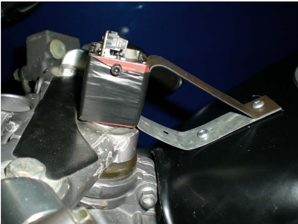
Figura 7.5 Potenciómetro rotatorio acoplado al manillar
