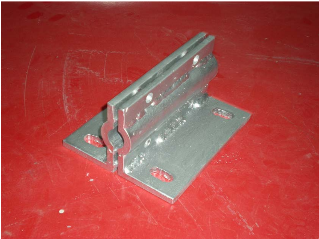
Figura 5.1 Freno de compresión externa sin material de fricción
