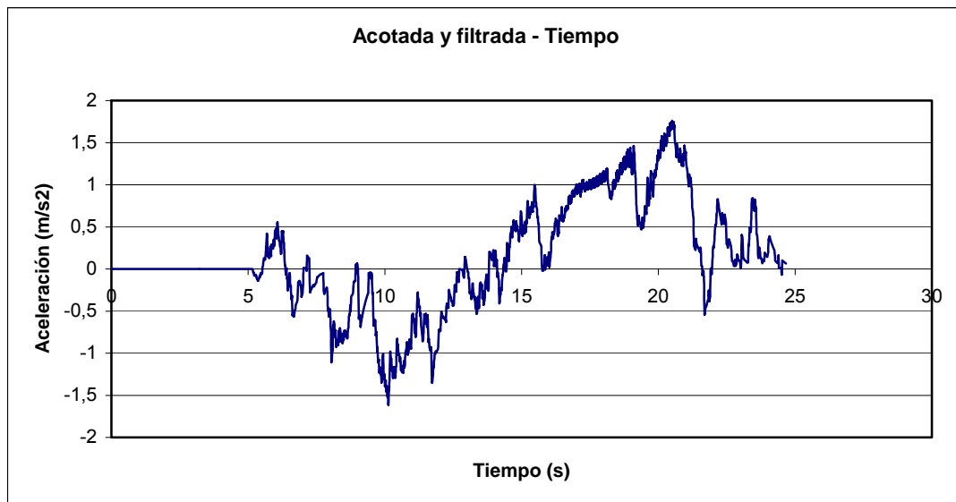
Figura 6.11 Aceleración vertical acotada y filtrada frente al tiempo
