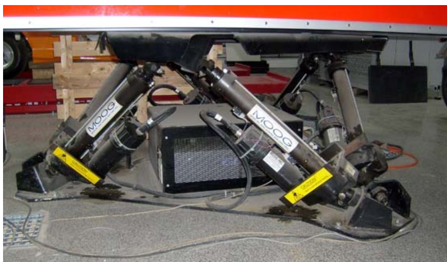
Figura 3.1 Primer plano plataforma Stewart
