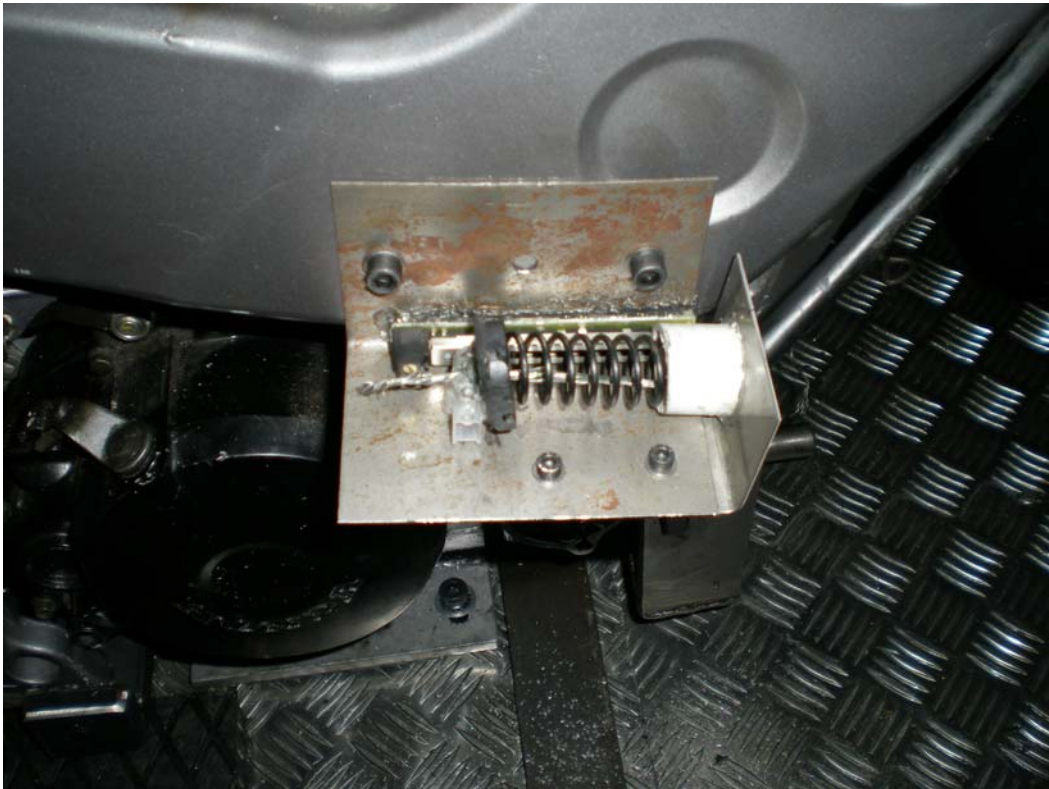
Figura 7.9 Potenciómetro deslizante para el embrague
