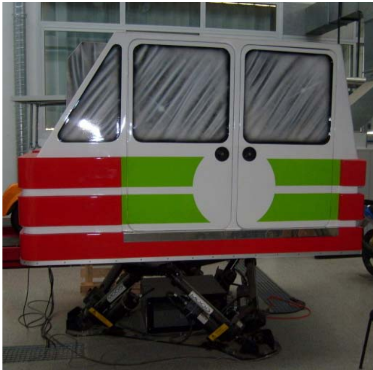
Figura 2.1 Cabina sobre plataforma Stewart
