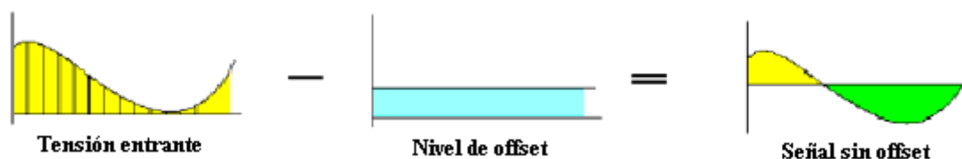
Figura 49: Formas de onda de la señal de un eje
