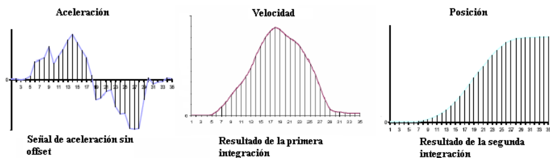
Figura 54: Doble integración de la aceleración
