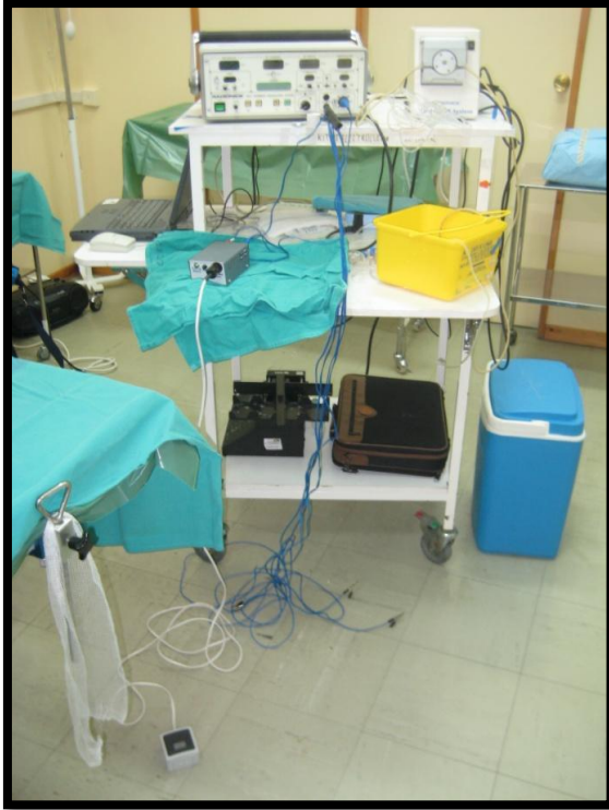
Foto3.10: Distintas conexiones: generador, bomba peristáltica del recipiente (amarillo) con suero y hielo pile al electrodo.
