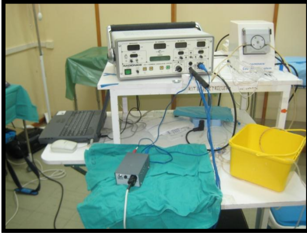
Foto 3.4: Generador de RF al que se conecta al electrodo, a la derecha en la foto bomba peristáltica que lleva suero frío de un recipiente (amarillo) al interior del electrodo y extracción del suero caliente introduciéndolo nuevamente en el recipiente (con hielo pile).
