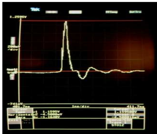
Figura 29. Medida del impulso a la salida del emisor
