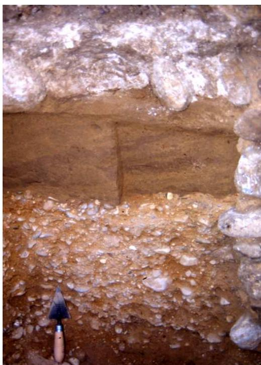
Fot. 146. Detalle de la composición de los niveles C (gravas) y D (arenas).
