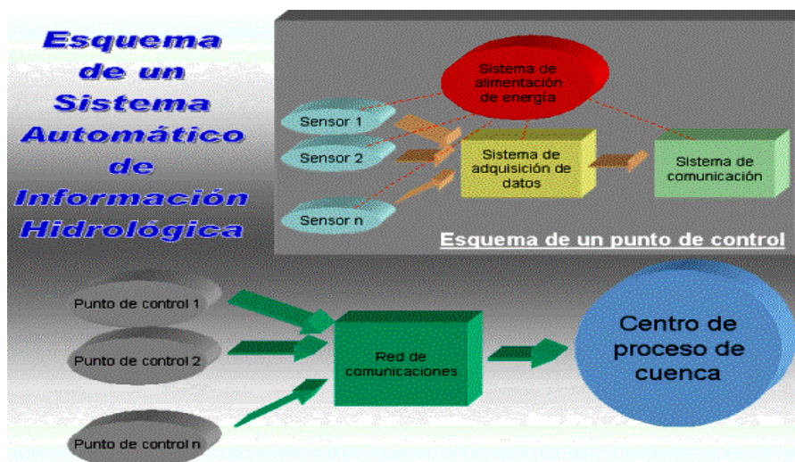
Figura 3.2.1 Esquema de funcionamiento del SAIH.
