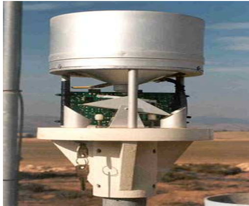
Figura 3.2.3 Pluviómetro tipo usado por los SAIH.
