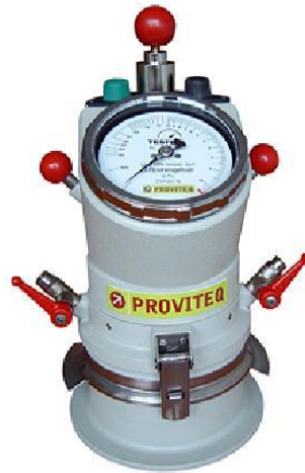
Figura E.3 Dispositivo para la medición por el método manométrico del contenido en aire de mortero
