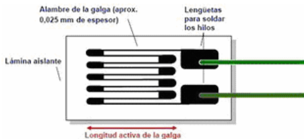
Figura 2.6 Esquema de un Extensómetro de Resistencia Eléctrica.
