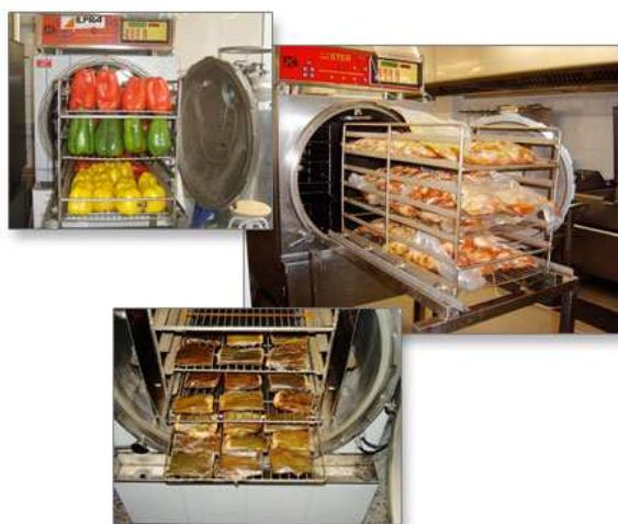
Figura 2.37 Esterilización con Autoclaves de Alimentos.
