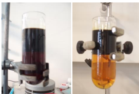
Fotografía V.1 Aspecto físico de las fases del líquido de pirólisis antes (fotografía de la izquierda) y tras el uso del catalizador (fotografía de la derecha)
