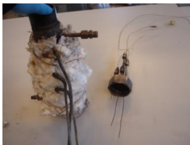
Fotografía II.9. Reactor de lecho fijo
