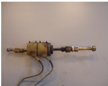
Fotografía II.7. Filtro en caliente
