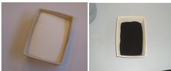
Fotografía IV.1 Apariencia del catalizador antes y después del experimento.
