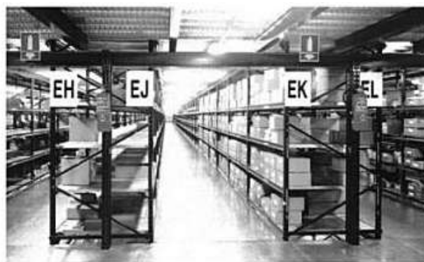
Figura 1 – Estanterías convencionales (manual picking). Fuente: ([Maul06], p.127)
