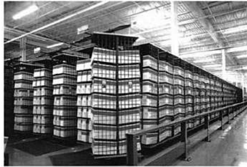
Figura 5 – Carrusel horizontal. Fuente: ([Maul06], p.128)
