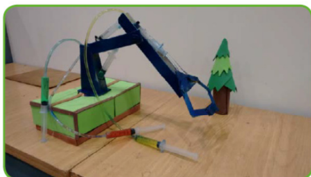
Grafico 1. Foto ejemplo de la maqueta de un Proyecto de Taller realizado en la asignatura. Foto obtenido de la Memoria Brazo hidráulico disponible en https://moodle2.unizar.es/add/course/view.php?id=10584&section=18
