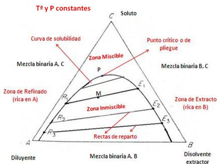
Figura 7. Diagrama triangular para el caso de dos líquidos, A (diluyente) y B (disolvente), parcialmente miscibles.
