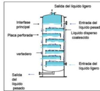
Caso de la columna de extracción con platos perforados
