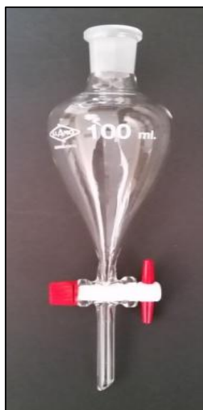
Figura 1. Embudo de decantación o de separación de 100 ml.
