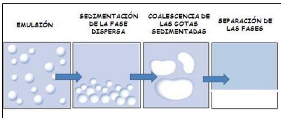
Figura 42. Las gotas de la fase dispersa sedimentan para después unirse o coalescer, permitiendo de esa manera la separación de las dos fases líquidas.
