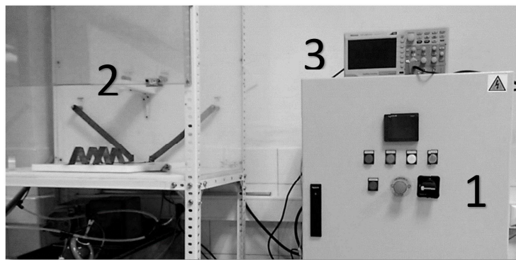
Figura 4. Equipo de pulsos eléctricos de alto voltaje (PEAV) de onda cuadrada. (1) Generador de pulsos (2) Zona de tratamiento (3) Osciloscopio
