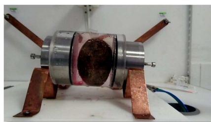
Figura 4B. Cámara de tratamiento con la remolacha roja en la zona de tratamiento del equipo de PEAV.
