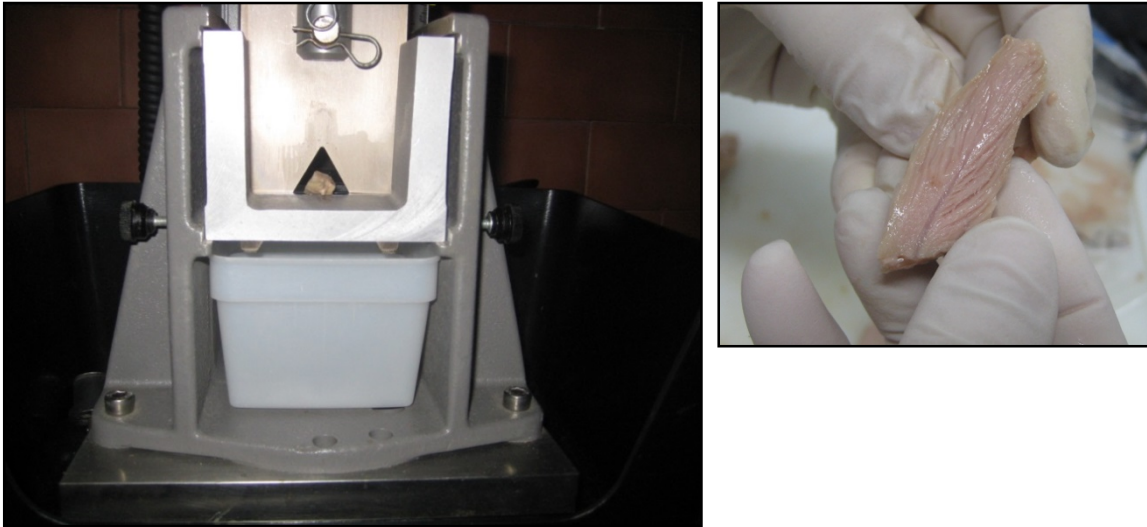
Figura 5. Medición del esfuerzo mediante una célula Warner-Braztler en un Instron 4301.
