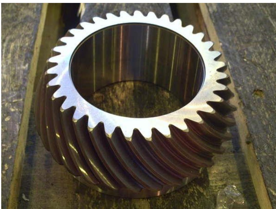
Figura 104. Engranaje templado con láser
