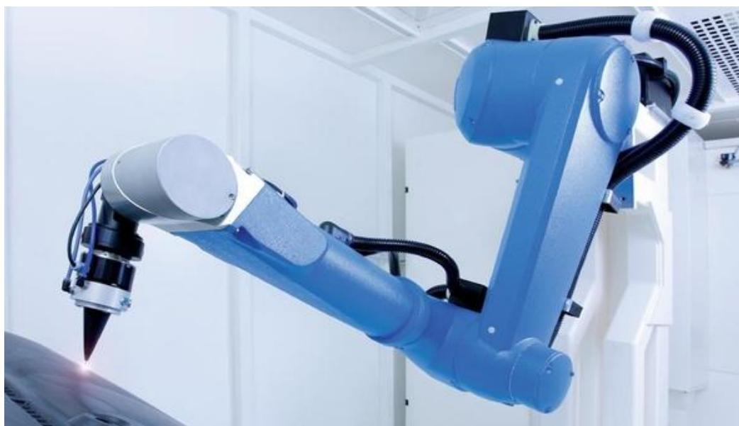
Figura 50. Robot para corte por láser. El haz llega al cabezal por fibra óptica.
