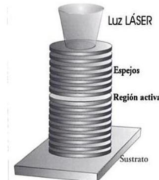
Figura 37. Geometría cilíndrica de un microláser.
