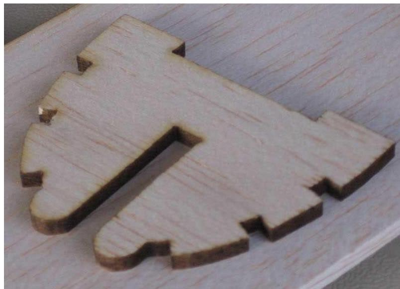
Figura 71. Contrachapado cortado con láser.
