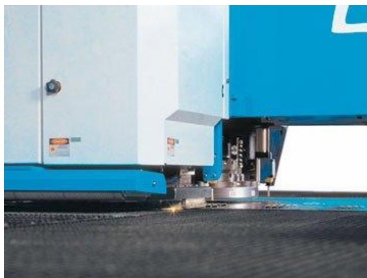
Figura 68. Máquina combinada punzonado-láser.
