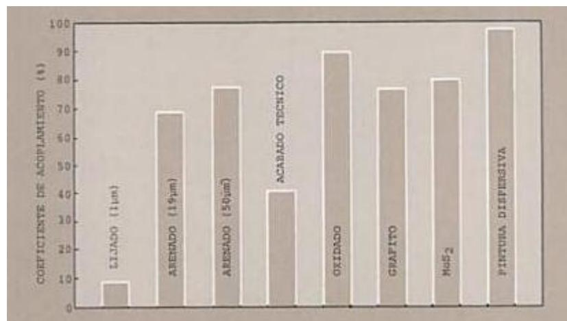
Figura 40. Coeficientes de acoplamiento para un metal con distintos acabados superficiales
