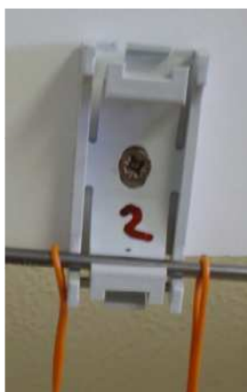
Figura 7.8 Ensayo del colgado vertical real del anclaje estrecho.
