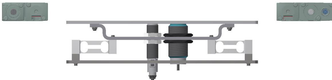
Figura 40: Vista de perfil de la disposición de las barreras de medición
