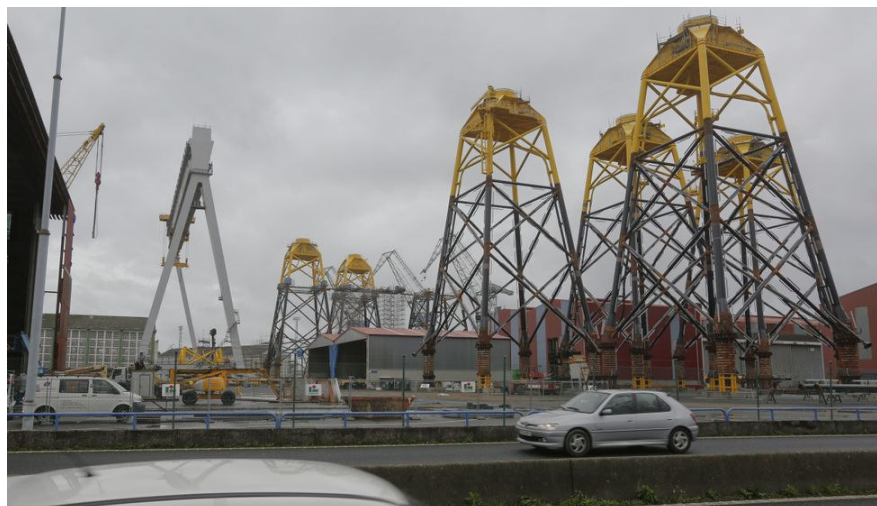
Ilustración 18 Plataformas jacket en astillero ("Navantia fabrica cuatro «jackets» al mes y ultima las seis primeras," 2016)
