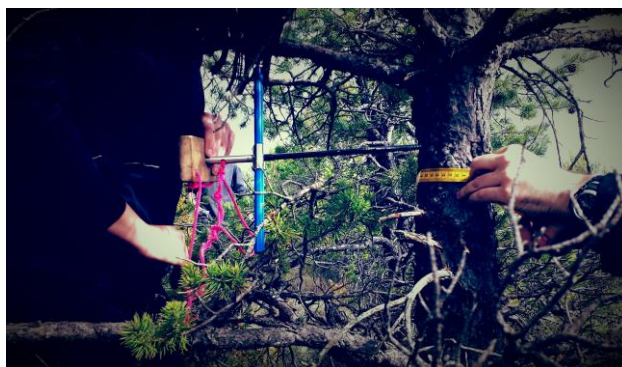
Ilustración. 5. Barrena Pressler (izq) y extracción core con medición del diámetro (dcha) Pinus sylvestris . Elaboración propia.
