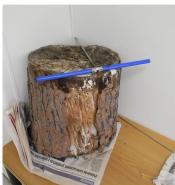
Ilustración. 5. Barrena Pressler (izq) y extracción core con medición del diámetro (dcha) Pinus sylvestris . Elaboración propia.
