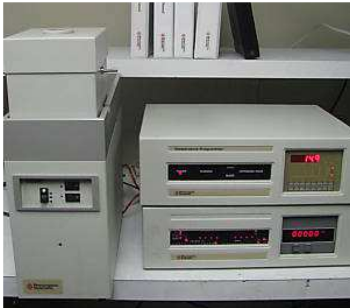
Figura 9. Equipo utilizado para el ensayo dmta.
