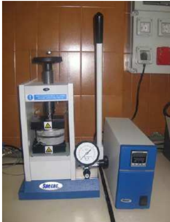
Figura 4. Prensa hidráulica utilizada para realizar el termoconformado.
