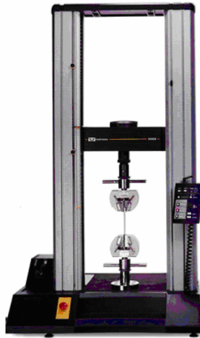
Figura 7. Máquina Instron 5565 utilizada para los ensayos de tracción
