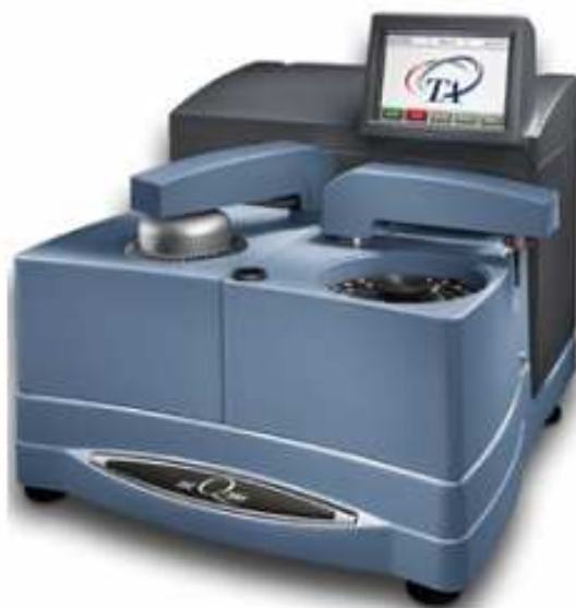
Figura 8. Equipo DSC utilizado para este ensayo.
