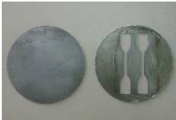
Figura 5. Molde utilizado para la obtención de probetas en el proceso de moldeo por compresión.
