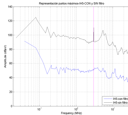
Gráfica 3.4: Detector de picos máximos, ancho de banda = 30 kHz/250 kHz
