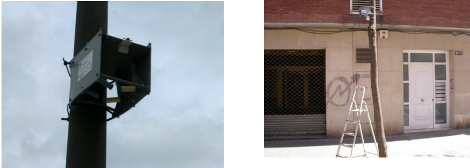
Figura 1: Foto de captador pasivo y caja protectora. Fuente: proyecto inma.org
