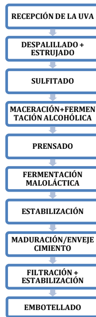
Figura 2.1. Diagrama de flujo del proceso de elaboración del vino tinto.
