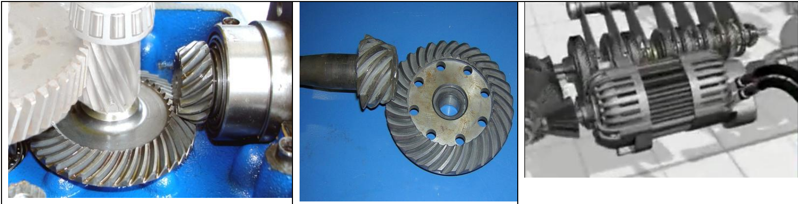
Figs.16, 17 y 18 Engranaje cónico hipoide formado por la salida del KERS y la corona cónica
