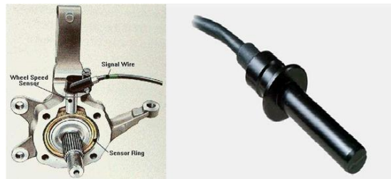
Figs. 17 y 18 Sensores de velocidad inductivo y de Efecto Hall
