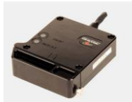
Fig. 12 Registrador de datos en tarjeta SD Data TAG © McLaren Electronics
