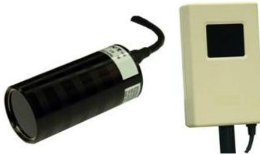
Fig. 14 Disparador de vuelta y receptor óptico por vuelta. © McLaren Electronics
