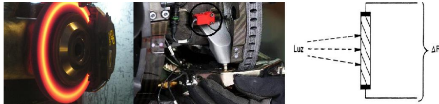
Fig. 31 Sensor fotoconductor usado para medir la temperatura de los frenos
