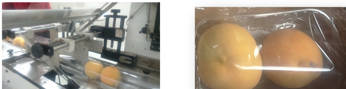
Figura 9. Proceso de envasado en flow-pack (izqda) y envase de melocotones dispuesto para su conservación (dcha).
