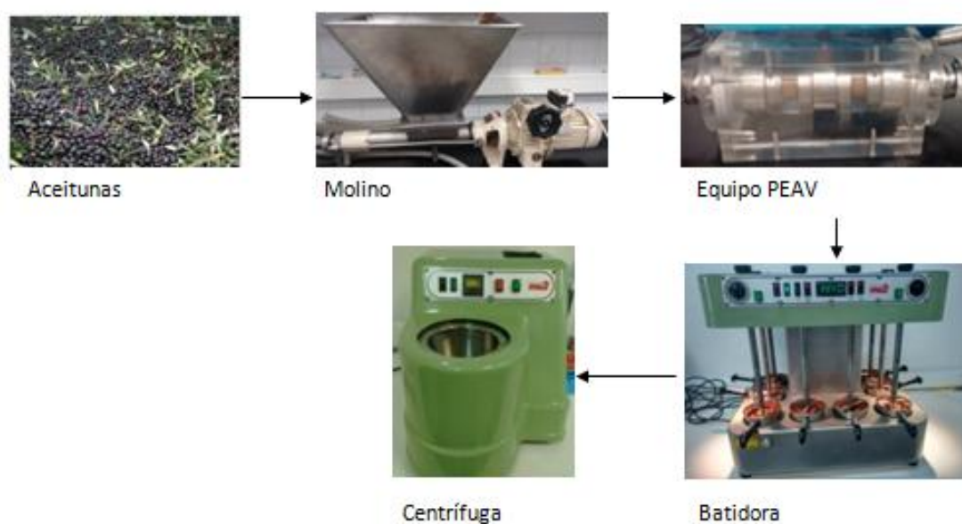
Figura 5. Esquema del procesado del aceite con el tratamiento de PEAV.
