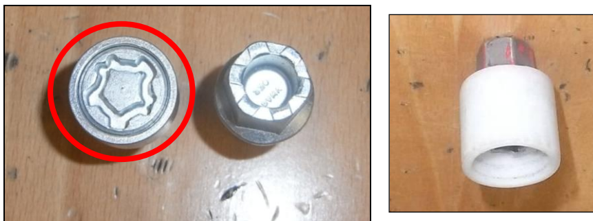
Figura H.7 Izq. Tornillos especial. Dcha. Adaptador para atornillar.
