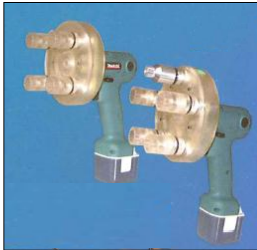
Figura H.3 Atornillador especial de cuatro y cinco husillos
