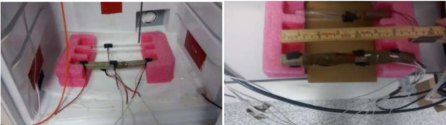
Figura VII.4 Montaje de varias sondas, izquierda ensayo 2; derecha ensayo 3
