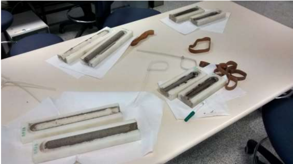
Figura III.12 Proceso de desmoldeo
