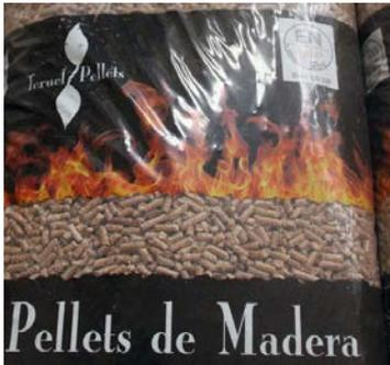
Se elaboran a partir de serrín natural seco, sin ningún aditivo, ya que se utiliza la propia lignina que contiene el serrín como aglomerante, comprimiendo el serrín a una alta presión para formar el *pellet*, lo que hace que los *pellets* tengan una composición muy densa y dura, consiguiendo con ello un gran poder calorífico.
