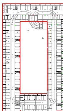
Figura 4.7. Muros de contención de los edificios de la parcela 12 (resaltados en color rojo)
