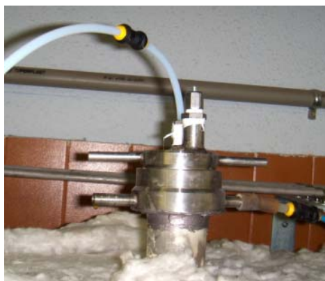
Figura B.5. Entrada de los gases al reactor
