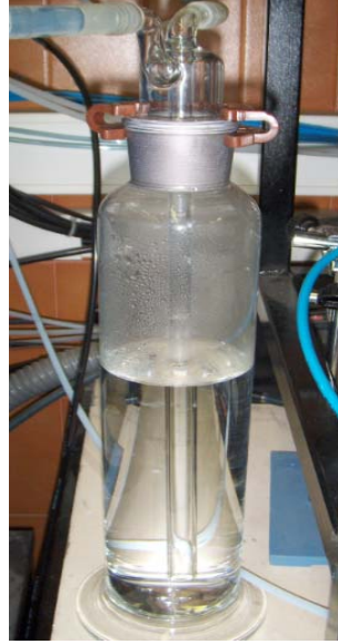
Figura B.2. Sistema de inyección de agua. Borboteador
