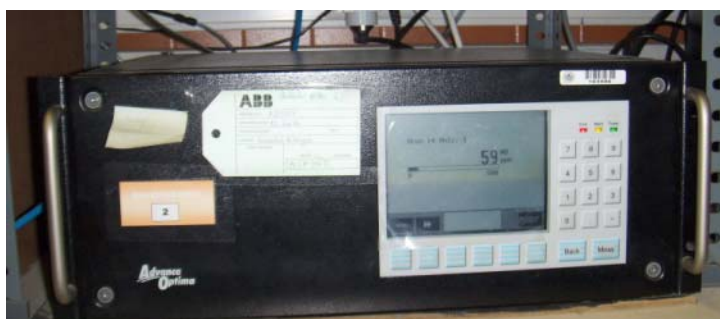
Figura B.10. Analizador de NO. ABB (Modelo URAS14)
