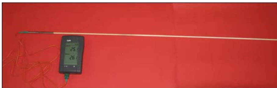
Figura C.1. Termopar de tipo S con vaina cerámica
