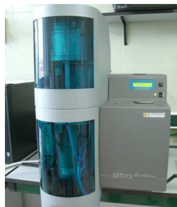
Figura D7.1. Izquierda: análisis TGA de CNF700 y Pt/CNF700. Derecha: equipo termogravimétrico.
