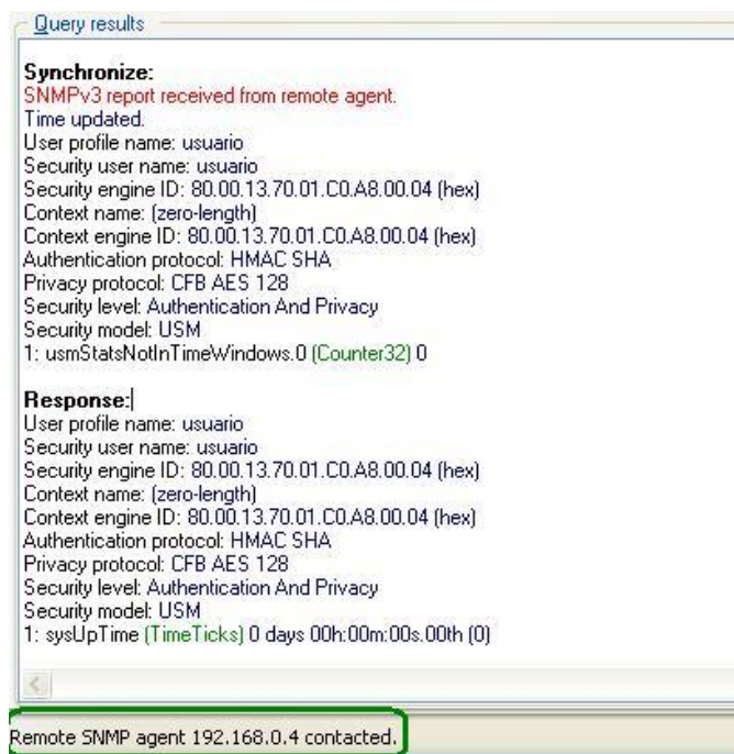
Figura A.5. Agente conectado con éxito al gestor SNMPv3.
