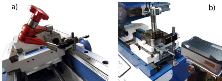
Figura 4.8 Medición de errores en guías lineales; a) Reloj comparador; b) Interferómetro láser
