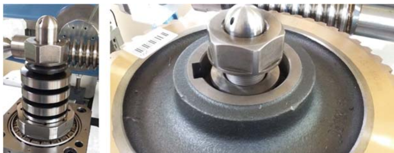
Figura 5.8 Montaje corona mediante pinza expansora
