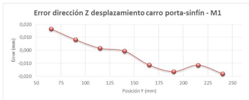
Figura 4.22 Error del sinfín en el eje Z por el desplazamiento en dirección Y
