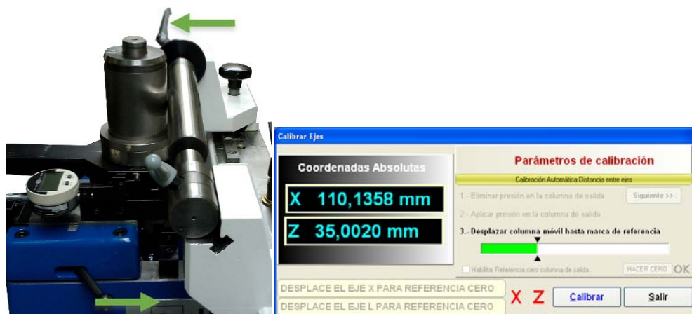
Figura 4.49 Ejemplo de calibración automática en M1
