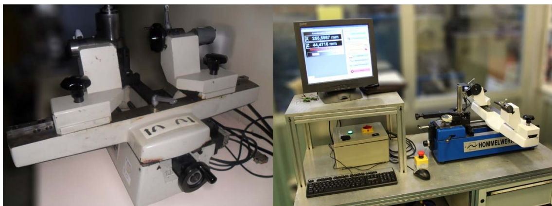
Figura 3.10 Retrofit máquina de ensayos de rodadura a dos flancos
