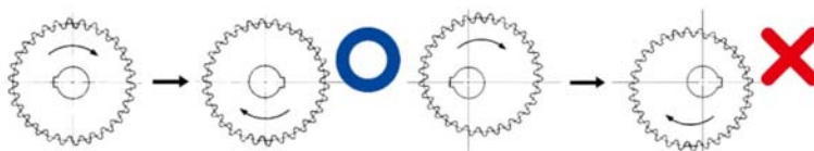
Figura 2.17 Excentricidad de la rueda (fuente: KHK)
