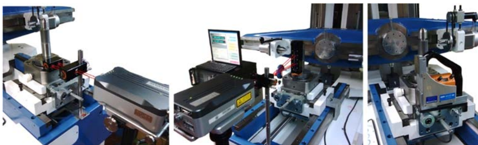
Figura 4.25 Medición mediante interferometría láser y nivel electrónico en M2
