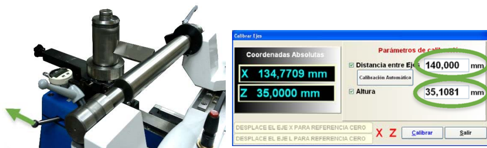
Figura 4.48 Ejemplo recalibración de los instrumentos de medida mediante galgas en M1
