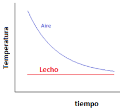
Figura 3: Evolución de la temperatura del lecho y el aire en un intervalo en el interior del secadero.
