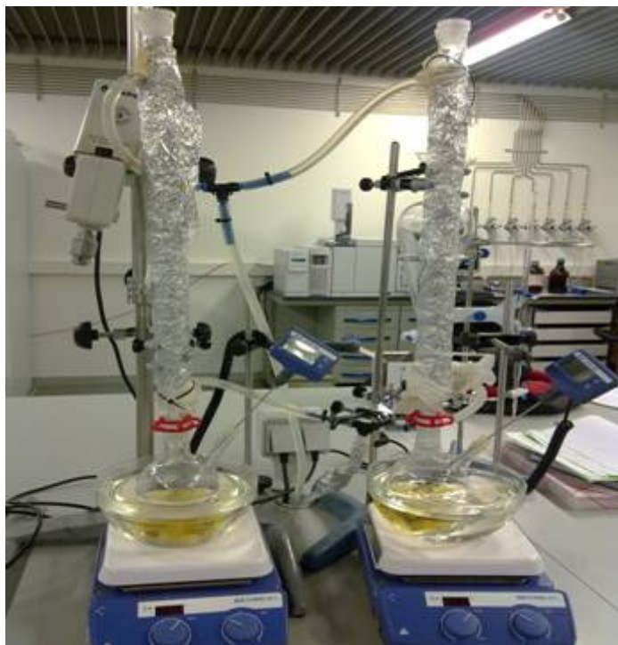
Figura A-IV.2 Instalación para la producción de acetatos de glicerina
