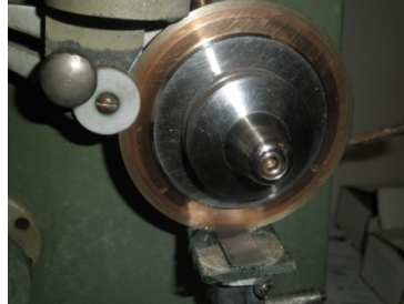
Ilustración 23: Corte de una muestra con disco de diamante.
