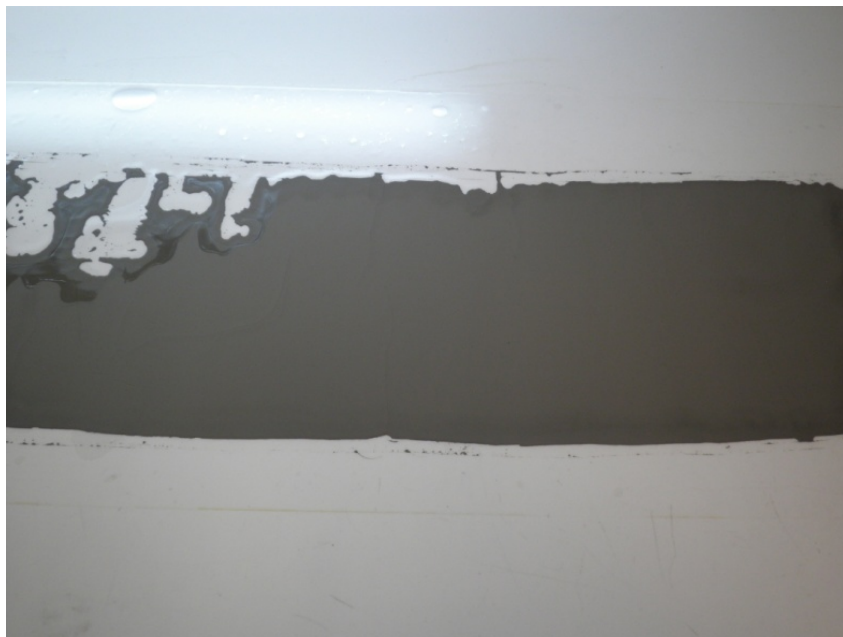
Ilustración 22: Cinta realizada por tape-casting, con problemas de ajuste en la suspensión.
