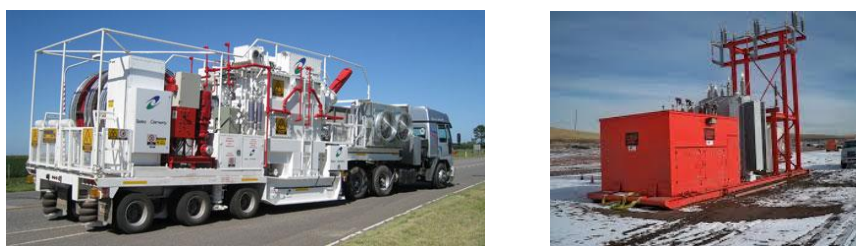
Figura 3 - S.E tipo camion y plataforma.
