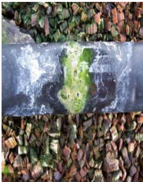
Imagen 1. Gotero con crecimiento de algas y bacterias
