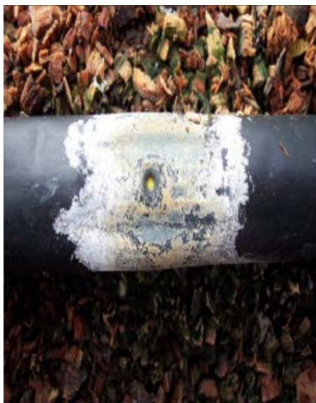
Imagen 2. Gotero con depósito de calcio, magnesio, etc.
