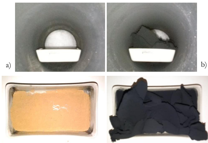
Figura 2-4 a) catalizador soportado basado en Fe-Mo en una navecilla de porcelana alojada en el interior del reactor rotatorio en modo de lecho fijo horizontal y b) CNT generados tras la DCM.
