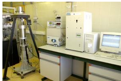
Figura 2-1 Esquema e imagen del sistema termo-gravimétrico CAHN TG-2151.
