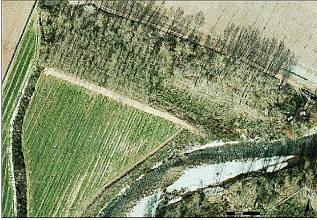
Figura 18. Barra o banco de cantos depositado por la pérdida de energía en flujo al atravesar los árboles, dispuestos transversalmente al flujo. Obsérvese la morfología longitudinal de la barra y su disposición ortogonal al flujo principal. Elaboración propia.
