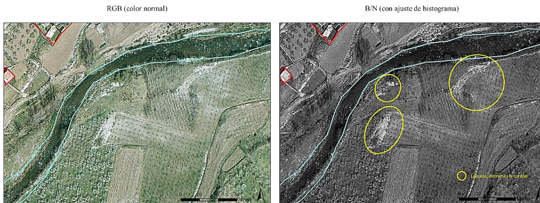
Figura 32. Diferenciación de múltiples lóbulos de derrames en el río Iregua con su tratamiento del histograma y en B/N. Elaboración propia.
