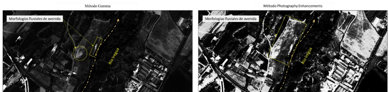
Figura 19. Uso de diferentes métodos de ajuste de contraste. Método gamma (izquierda) y método Photography Enhancements (derecha). Elaboración propia.
