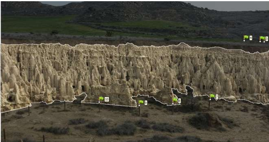
Figura 9: Eliminación de ruidos mediante la creación de máscara. Programa Agisoft PhotoScan.
