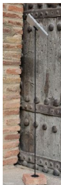
Diferentes vistas del soporte, elaborado en ladrillo, varilla metálica y cartón pluma
