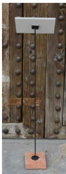
Diferentes vistas del soporte, elaborado en ladrillo, varilla metálica y cartón pluma
