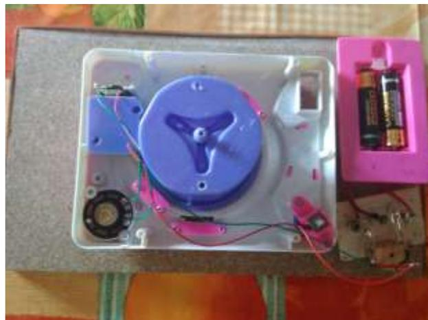
**Figura 9:** Base del brazo con conmutador casero que permite la inversión del motor.
