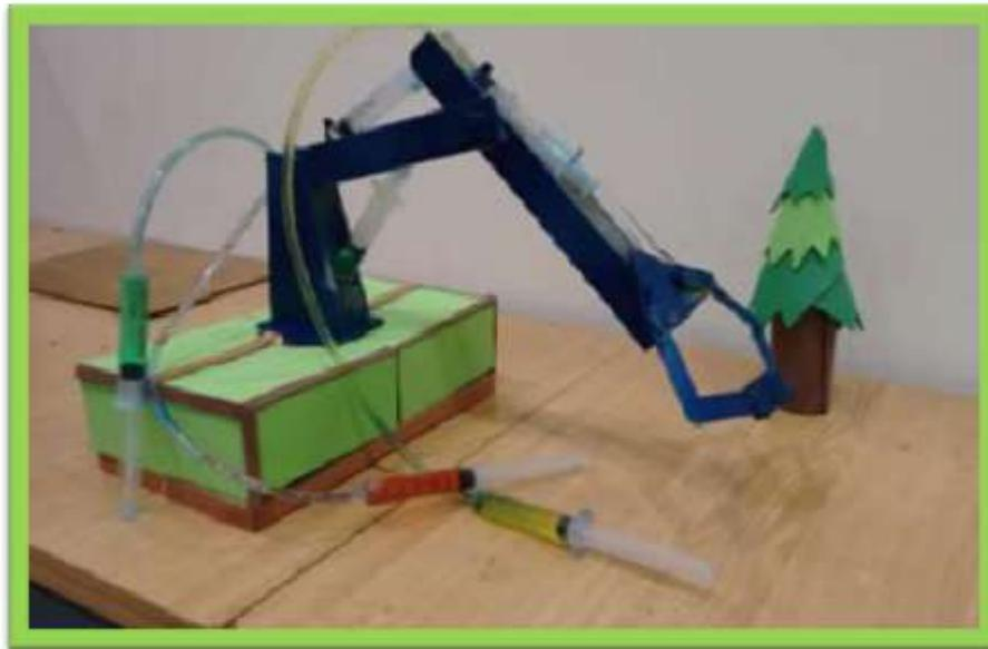
**Figura 4:** Proyecto de brazo hidráulico con giro de motor.
